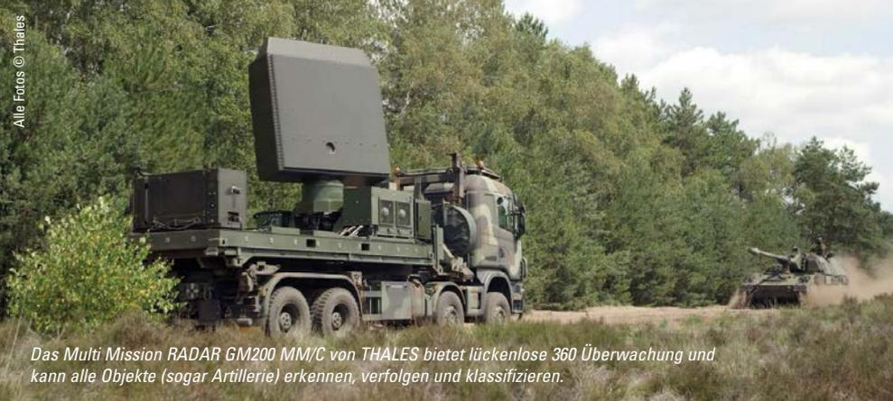
Das Multi Mission RADAR GM200 MM/C von THALES bietet lückenlose 360 Überwachung und kann alle Objekte (sogar Artillerie) erkennen, verfolgen und klassifizieren.
